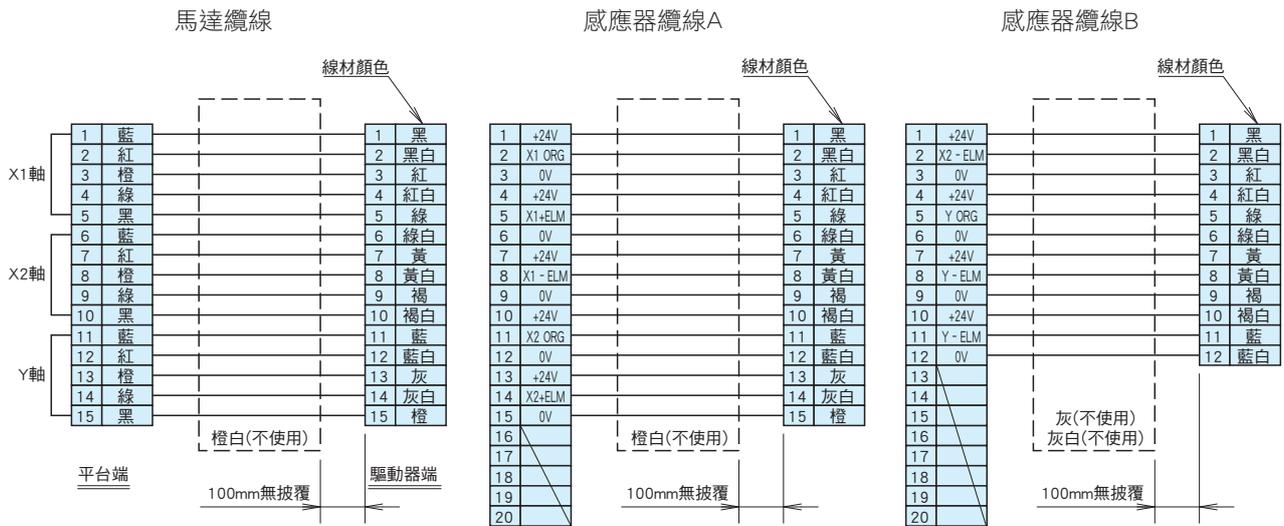
※1 平台端的連接，請直接連接到平台的基座部的專用連接頭。
