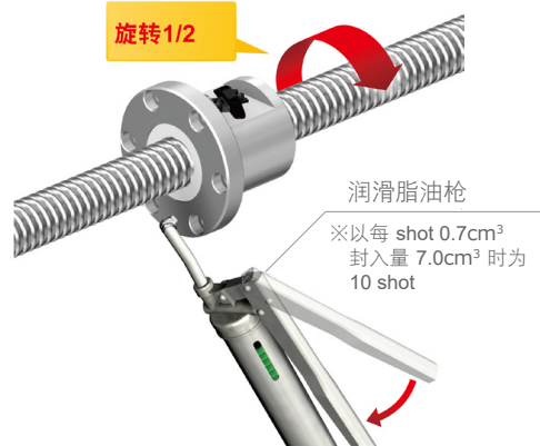
图 4-1 使用润滑脂油枪封入
